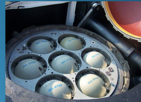
Lanceur septuple de missiles de croisière installé dans un ancien tube de missile MSBS sur un ex-SSBN US converti en SSGN
