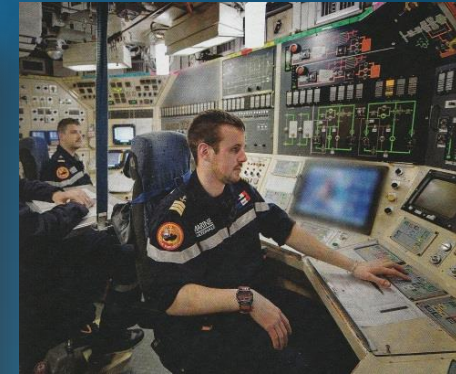
Poste central « Propulsion » (PCP)
