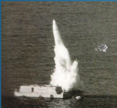
Tir maquette missile MSBS depuis le caisson « NEMO »
