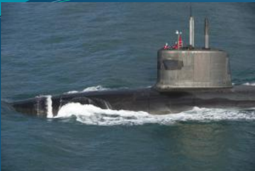
SNLE type Le « TRIOMPHANT » navigant par mer belle en surface (on appréciera le côté esthétique, mais aussi fonctionnel, de ses formes, étudiées pour optimiser son hydrodynamisme)
