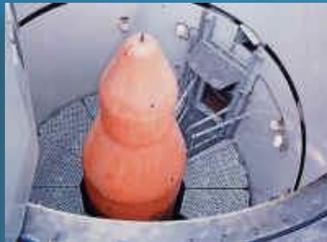
Missile SSBS de 1ère génération en silo sur le plateau d'Albion
