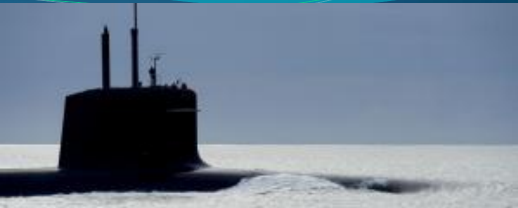
SNLE type Le « TRIOMPHANT » navigant par mer belle en surface (on appréciera le côté esthétique, mais aussi fonctionnel, de ses formes, étudiées pour optimiser son hydrodynamisme)
