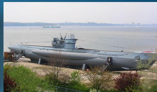
U-boot type VII (propulsion Diesel – électrique), qui équipa massivement les forces sous-marines allemandes durant la 2 ème guerre mondiale
