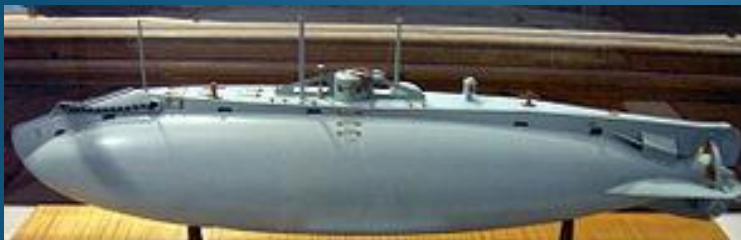
Le S/M « Holland n°1 » (1895) de John Holland, ingénieur irlandais. Ce S/M possède une double propulsion, moteur à combustion interne en surface/électricité (moteur électrique + batteries) en plongée.
