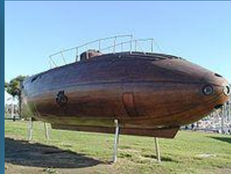
« L'ICTINEO II » (Espagne-1864) 1 er S/M utilisant un double mode de propulsion - Moteur à vapeur en surface et combustion chimique (avec peroxyde comme comburant) en plongée. Projet resté sans suite
